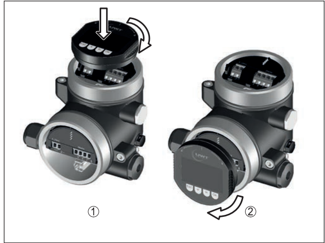
Fig. 11: Empleo del módulo de visualización y configuración en carcasa de dos cámaras
