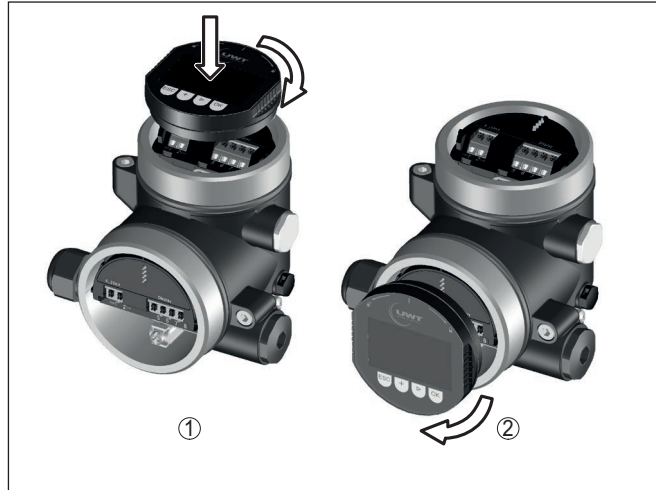
Abb. 11: Einsetzen des Anzeige- und Bedienmoduls beim Zweikammergehäuse
