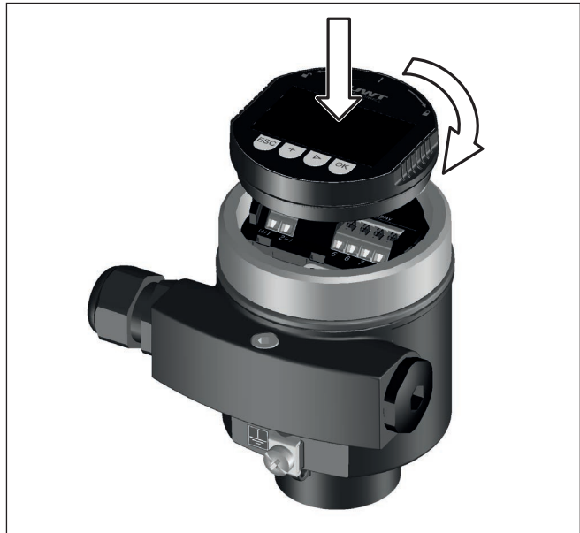
Fig. 9: Montage du module d'affichage et de réglage dans le boîtier à chambre unique se trouvant dans le compartiment de l'électronique
