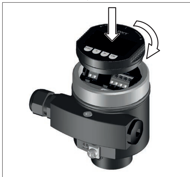
Fig. 9: Montage du module d'affichage et de réglage dans le boîtier à chambre unique se trouvant dans le compartiment de l'électronique
