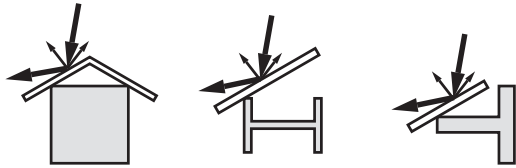
插图. 16: 用散射挡板来覆盖光滑的型材
