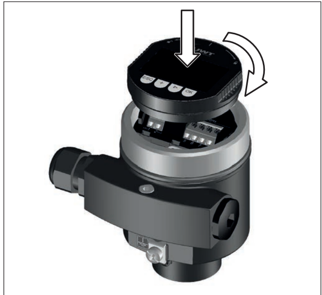
Fig. 10: Montage du module d'affichage et de réglage dans le boîtier à chambre unique se trouvant dans le compartiment de l'électronique
